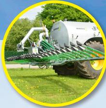
Elevador anti-goteo integrado (sistema TWIST)
